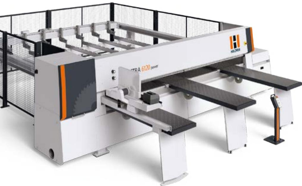
Il suo piatto forte è la soluzione continua adottata per le guide lineari. Il carro lama all'interno della macchina, per esempio, scorre completamente su guide lineari. Ciò offre una produzione in assoluta sicurezza, velocità e prestazioni. Anche per quanto riguarda la sicurezza, la nuova serie TECTRA è in prima fila. Con la sua certificazione secondo le norme DGUV risponde ai più alti standard di sicurezza – il vostro garante per un posto di lavoro sicuro.
